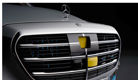
Zusätzlich für den Autobahnassistenten gemäss SAE-Level-3 besitzt die neue S-Klasse zusätzlich zum Fernbereichsradar einen Lidar-Sensor (gegen Aufpreis). Die Redundanz ermöglicht autonomes Fahren im Stau bis 60 km/h auf der Autobahn. Quelle: Mercedes-Benz
